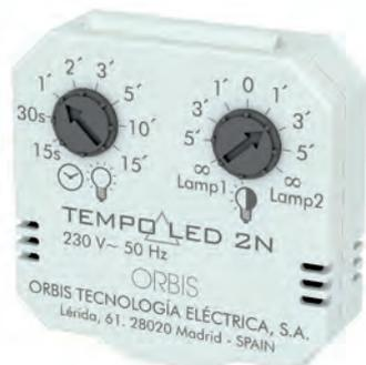
**Temporizzatore a doppio livello da retrofrutto.** Trascorso il tempo principale impostato è possibile tenere spente le luci o attivarle al 25% della luminosità massima per un tempo regolabile (preavviso di spegnimento) o fino alla prossima accensione (come luci di cortesia). Adatto per tutti i tipi di lampade LED regolabili a 230 V o con trasformatore elettronico, lampade basso consumo oltre alle classiche alogene/incandescenza.
