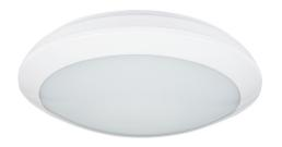
Plafoniera LED con doppio livello di illuminazione che si accende mediante rivelatore di movimento con tecnologia ad alta frequenza integrato. Quando cessa di rilevare un movimento, trascorso il tempo di ritardo allo spegnimento impostato, la lampada si può spegnere o rimanere accesa con un livello di luminosità al 30% del valore massimo per un tempo determinato (preavviso di spegnimento) o per un tempo infinito (luce di cortesia).
