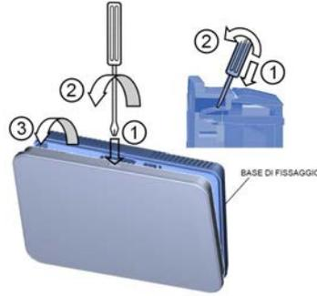
Cronotermostato NEXU+ IN (versione da incasso): Il dispositivo può essere montato a incasso tramite due viti (in dotazione) su una scatola 3 moduli serie civile tipo 503. Sganciare la base di fissaggio come indicato in figura ed effettuare i collegamenti. Fissare la base alla scatola 503 con le viti in dotazione e riposizionare il dispositivo sulla base.
