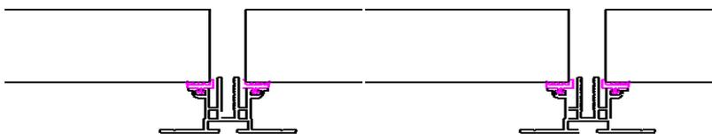
2. Avvitare i profili di base alla superficie sottostante mediante l'utilizzo di viti che devono essere definite in base alla tipologia di sottostruttura (legno, metallo, cemento ecc...).
