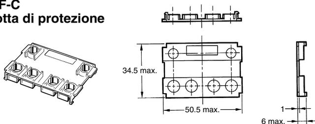
A protezione dell'utente, si monti sui relè con terminali a vite una calotta di protezione modello: P7LF-C.
