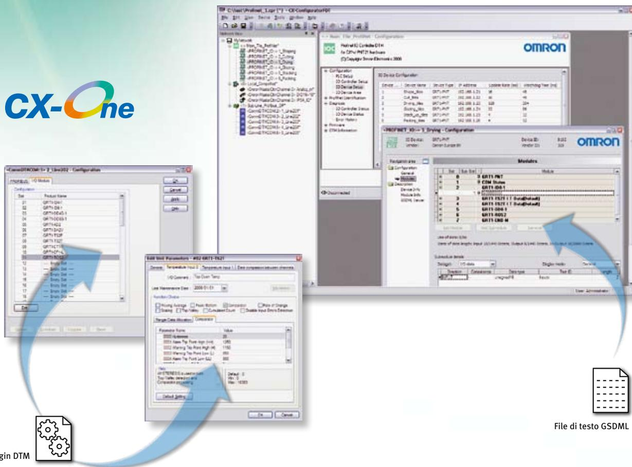
I prodotti Omron supportano PROFINET-IO per la comunicazione ciclica master-slave con caratteristiche real-time “soft”, conformemente ai requisiti dell’automazione industriale per impieghi generali. PROFINET-IO, la variante PROFINET più universale, è simile alla comunicazione fieldbus e offre maggiore flessibilità pur restando di facile utilizzo.
