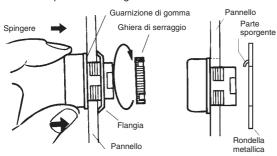
Se i fori nel pannello hanno Ø25, togliere la guarnizione di gomma in dotazione ed installare al suo posto l'anello adattatore come mostrato di seguito (l'A22Z-R25 è disponibile a richiesta).
