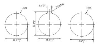
Per i fori con Ø25, usare sempre l'anello adattatore per garantire che il grado di protezione IP65.
