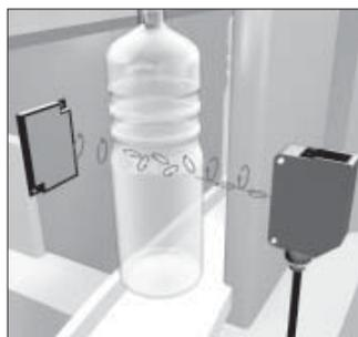
Utilizzo dell'effetto a doppia riflessione per il PET: maggiore stabilità di rilevamento (modelli ottimizzati per PET)
