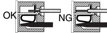
**2.** Se il diametro esterno D del cavo supera i 3,2 mm, potrebbe essere difficile realizzare un doppio cablaggio.
