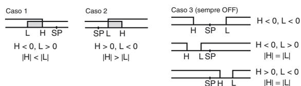
\*4. Valore impostato: 5, limite superiore e inferiore con sequenza di attesa
