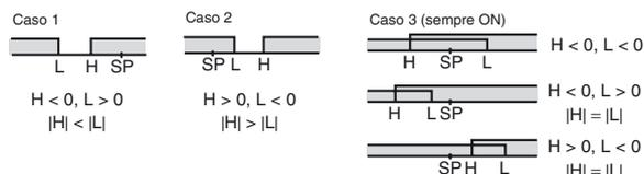
\*3. Valore impostato: 4, campo limite superiore e inferiore
