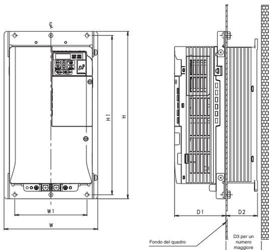
Dima di foratura per il montaggio esterno del dissipatore
