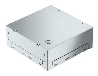
Scatola massetto quadrata per alloggiamento GES9-3 per l'impiego in pavimenti a massetto e in ambienti interni. Con aperture preforate per tubi (M25) su tutti i lati
