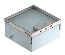
Torretta a scomparsa 'all-in-one' per l'installazione in pavimenti in massetto o sopraelevato con lavaggio a secco. Alloggiamento da incasso con aperture pretranciate per tubi (M25). Parte superiore regolabile al bordo superiore del rivestimento grazie a 4 supporti di regolazione integrati. La profondità minima di installazione è di 110 mm, il campo di regolazione di + 30 mm. Telaio e coperchio visibili in acciaio inox satinato. Coperchio rivestibile fino a 15 mm.
