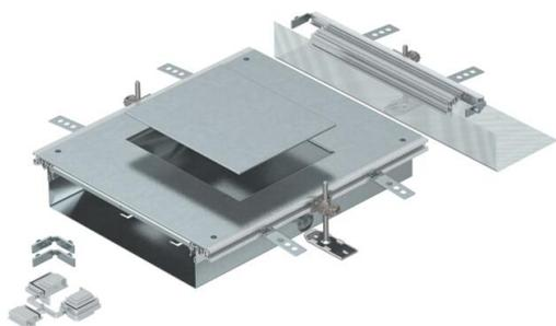
Unità di estensione del canale preassemblato con un coperchio con apertura installazione per torretta rettangolare dimensione nominale 6, costituito dalla parte inferiore del canale (base con profili laterali e di rivestimento pavimento), coperchio del canale con apertura installazione con piastra cieca e un elemento terminale. Nella dotazione di serie sono compresi 3 unità di regolazione livellabili in altezza, 3 ancoraggi per massetto, 1 giunto coperchio e 1 set di raccordi per angolo 90°.
