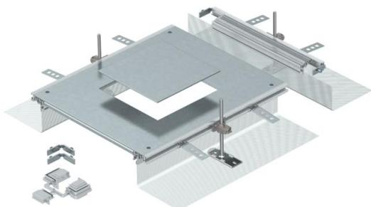
Unità di estensione del canale preassemblato con un coperchio con apertura installazione per torretta quadrata dimensione nominale 4, costituita da due profili laterali in tessuto metallico, profili di rivestimento coperchio e un elemento terminale. Nella dotazione di serie sono compresi 3 unità di regolazione livellabili in altezza, 3 ancoraggi per massetto, 1 giunto coperchio (senza unità di regolazione, da ordinare separatamente) e 1 set di raccordi T e incroci.
