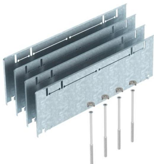
Set di regolazione altezza per scatole massetto UZD350 (con regolazione standard da 115 a 170 mm), composto da 4 piastre, 4 viti di regolazione livellamento e 4 nottolini di chiusura.
