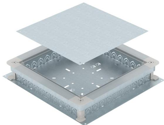
Scatola massetto con pareti laterali predisposte per l'ingresso di 10 tubi su ciascun lato (M20 o M32). Adatte per l'installazione di torrette a scomparsa grazie ai coperchi di montaggio (da ordinare separatamente).
