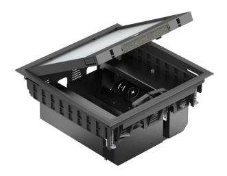
Torretta a scomparsa con maniglia ed uscita cavi orientabile con guarnizione in materiale espanso. Il coperchio incernierato è dotato di una piastra di rinforzo strutturale in lamiera d'acciaio con spessore di 4 mm e permette l'installazione di un rivestimento pavimento di 5 mm (regolabile anche a 10 mm).
