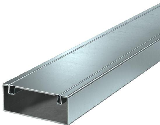
Canale in metallo con tessuto antincendio intumescente per la posa ignifuga dei cavi. Classificato come canale di installazione EI30, EI60 e EI90 a norma EN 13501-2, verificato secondo la norma EN 1366-5. Il canale impedisce la propagazione dell'incendio per l'intervallo di tempo classificato e protegge dalle conseguenze dell'incendio dei cavi.
