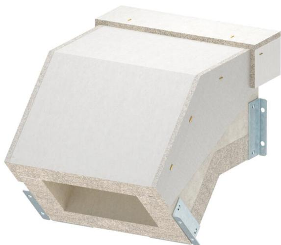
Curva verticale in discesa per canale antincendio PYROLINE® Con S EI90, tipo PLCS D091220 in calcestruzzo leggero con fibra di vetro resistente all'acqua e al gelo per realizzare variazioni di direzione verticali (45°) nello sviluppo del canale. I materiali di collegamento consentono un rapido montaggio, i coperchi consentono una rapida ispezione e successiva implementazione.
