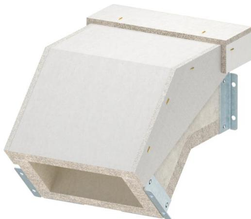
Curva verticale in discesa per canale antincendio PYROLINE® Con S EI60, tipo PLCS D061220 in calcestruzzo leggero con fibra di vetro resistente all'acqua e al gelo per realizzare variazioni di direzione verticali (45°) nello sviluppo del canale. I materiali di collegamento consentono un rapido montaggio, i coperchi consentono una rapida ispezione e successiva implementazione.
