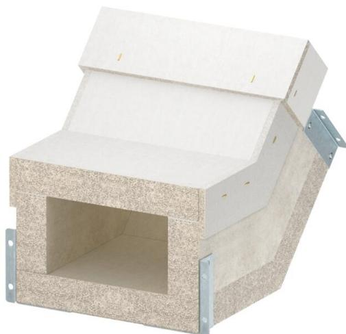
Curva verticale in salita per canale antincendio PYROLINE® Con S EI90, tipo PLCS D091220 in calcestruzzo leggero con fibra di vetro resistente all'acqua e al gelo per realizzare variazioni di direzione verticali (45°) nello sviluppo del canale. I materiali di collegamento consentono un rapido montaggio, i coperchi consentono una rapida ispezione e successiva implementazione.
