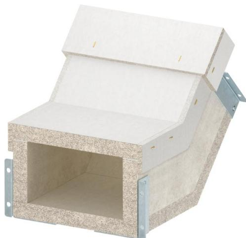
Curva verticale in salita per canale antincendio PYROLINE® Con S EI60, tipo PLCS D061220 in calcestruzzo leggero con fibra di vetro resistente all'acqua e al gelo per realizzare variazioni di direzione verticali (45°) nello sviluppo del canale. I materiali di collegamento consentono un rapido montaggio, i coperchi consentono una rapida ispezione e successiva implementazione.
