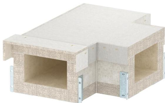
Raccordo a T per canale antincendio PYROLINE® Con S EI90, tipo PLCS D091220 in calcestruzzo leggero con fibra di vetro resistente all'acqua e al gelo per realizzare derivazioni a T nello sviluppo del canale. I materiali di collegamento consentono un rapido montaggio, i coperchi consentono una rapida ispezione e successiva implementazione.
