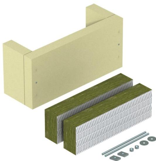
Compartimentazione locale come misura efficace per posa cavi verticale, secondo DIN 4102 parte 12, omologato per tutti i tipi di cavi e tutti i sistemi di posa verticale. Classe di mantenimento funzionale da E30 a E90. Alloggiamento incl. piastra in fibra minerale, materiale di fissaggio e cartuccia con rivestimento antincendio ASX e etichetta di contrassegno.
