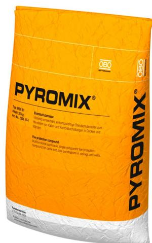
Malta antincendio per la realizzazione di isolamenti cavi combinati in pareti e soffitti. Idonea a pompe, dispositivi a pressione all'applicazione manuale. 20 kg di malta secca con l'aggiunta di circa 6 litri d'acqua forniscono circa 20 litri di massa lavorabile. Utilizzo in ambiente interno.
