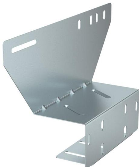
Piastra di montaggio universale per il fissaggio di FireBox serie T sulla parte anteriore delle passerelle portacavi, passerelle grigliate e passerelle a scaletta con altezza laterale max di 60 mm. Permette il montaggio sicuro dei cavi per il mantenimento funzionale senza doverli piegare. Idonea per tutte le FireBox.
