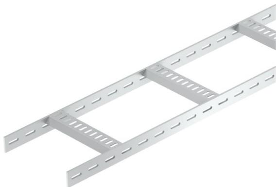
Passerella a traversini per impianti navali con longherone laterale asolato con bordo di altezza pari a 40 mm con pioli trapezoidali saldati, forati, aperti verso il basso.
