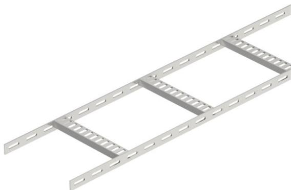
Passerella a traversini per impianti navali con longherone laterale asolato con bordo di altezza pari a 25 mm con pioli trapezoidali saldati, forati, aperti verso il basso. Carico testato secondo IEC in combinazione con connettore tipo SLV. La passerella per impianti navali è disponibile su richiesta anche in acciaio grezzo.
