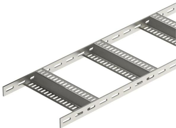
Passerella per impianti navali con longherone laterale asolato con bordo di altezza pari a 40 mm con pioli saldati, asolati, a Z. Carico testato secondo IEC in combinazione con connettore tipo SLV.
