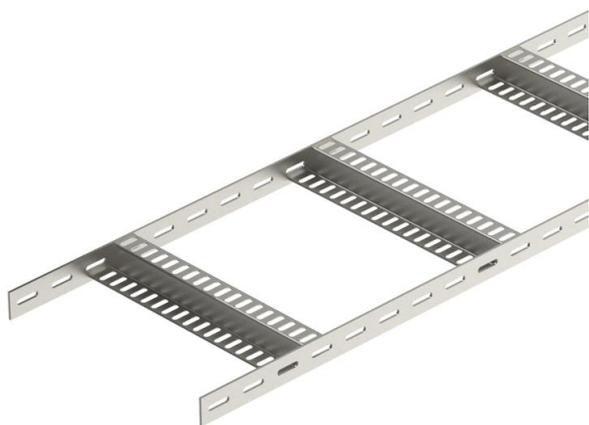
Passerella leggera per impianti navali con longherone laterale asolato con bordo di altezza pari a 35 mm con pioli saldati, forati, a Z. Carico testato secondo IEC in combinazione con connettore tipo SLV.
