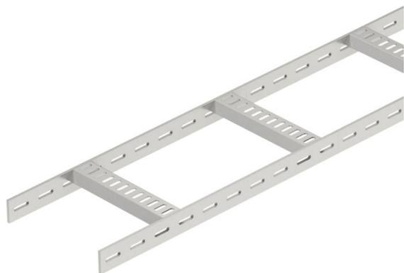
Scaletta portacavi per cantieristica navale con longherone laterale asolato, altezza laterale 40 mm, con pioli trapezoidali saldati e forati aperti nella parte inferiore. Carico testato secondo IEC in combinazione con connettore tipo SLV. La passerella per impianti navali è disponibile su richiesta anche in acciaio grezzo.
