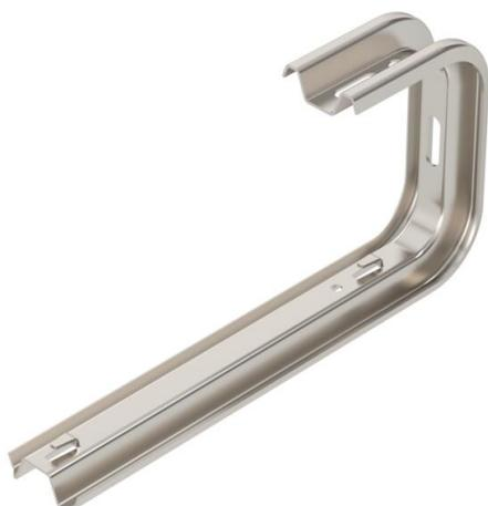
Staffa a parete e a soffitto TP per il fissaggio senza viti della passerella grigliata. Se il profilato viene fissato al soffitto o se viene avvitato con un altro profilato per il rinforzo delle estremità è necessario utilizzare sempre il distanziatore tipo DS 4 per garantire maggiore stabilità.
