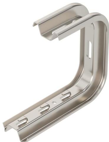
Staffa a parete e a soffitto TP per il fissaggio senza viti della passerella grigliata. Se il profilato viene fissato al soffitto o se viene avvitato con un altro profilato per il rinforzo delle estremità è necessario utilizzare sempre il distanziatore tipo DS 4 per garantire maggiore stabilità.
