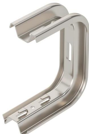
Staffa a parete e a soffitto TP per il fissaggio senza viti della passerella grigliata. Se il profilato viene fissato al soffitto o se viene avvitato con un altro profilato per il rinforzo delle estremità è necessario utilizzare sempre il distanziatore tipo DS 4 per garantire maggiore stabilità.
