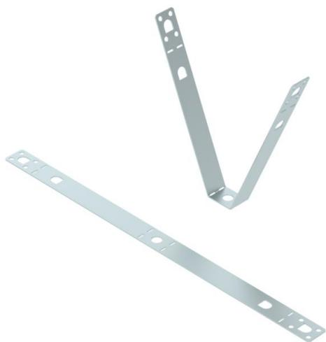
Fissaggio trapezoidale per il montaggio sospeso di sistemi portacavi su soffitti trapezoidali standard. Se si usano i fori previsti, il fissaggio trapezoidale può essere montato su un profilato trapezoidale di circa 165 mm di larghezza massima. Il fissaggio viene effettuato con viti per lamiera M4 o una vite a testa esagonale M10. Il componente non viene fornito piegato.
