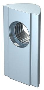
Dado scanalato con filettatura M8 per il montaggio di estensioni ed accessori. Un elemento di pressione della parte inferiore permette al blocco di attaccarsi alla scalanatura. Sicurezza antitorsione automatica tramite la profilatura della parte superiore.
