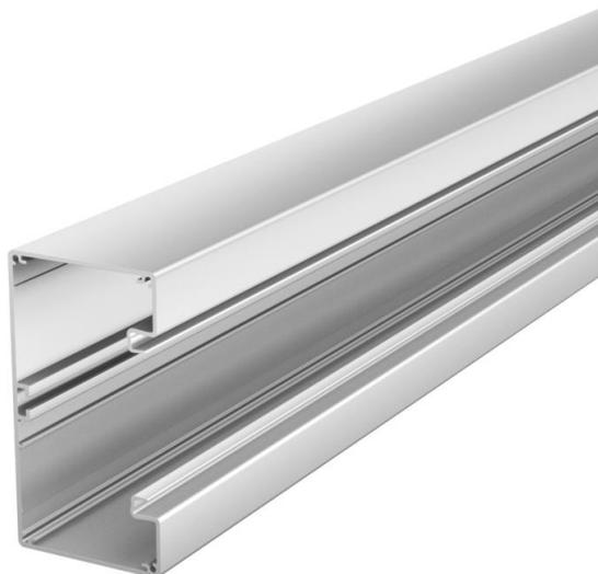
Canale porta apparecchi senza foratura alla base indicato per il montaggio diretto a parete o su mensole. Su richiesta possono essere realizzati anche elementi inferiori e superiori del canali e coperchi con lunghezze extra, fino a 6000 mm, e anche altri colori RAL. Le superfici esterne dei canali porta apparecchi sono laminate.
