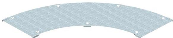
Coperchio per curva 90°, pesante, con bussole girevoli premontate. Poiché il connettore è montato dall'esterno, il coperchio del raccordo è più corto di 300 mm rispetto al raccordo corrispondente. Questo deve essere considerato quando si installano gli elementi della linea.
