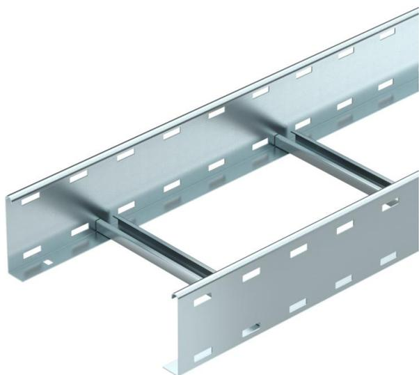
Passerella con longherone forato, con bordo di altezza pari a 110 mm, pioli del profilato a C rivettati e aperti verso l'alto.
