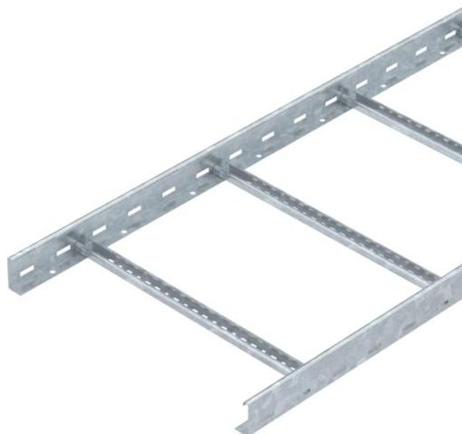
Passerella con longherone forato, con bordo di altezza pari a 60 mm, pioli del profilato a C rivettati e aperti verso l'alto (versione VS).
