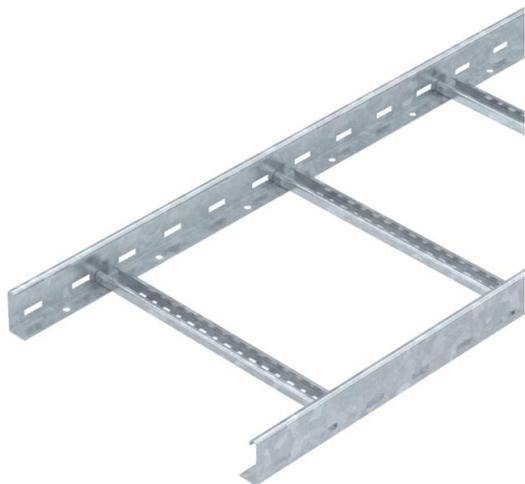
Passerella con longherone forato, con bordo di altezza pari a 60 mm, pioli del profilato a C rivettati e aperti verso l'alto (versione VS).
