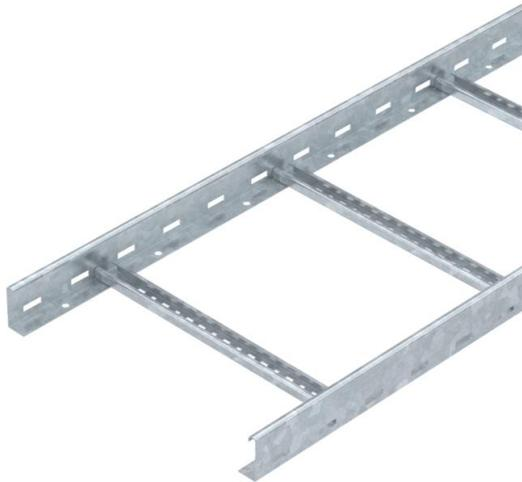
Passerella a travesini con longherone forato, con bordo di altezza pari a 60 mm, pioli del profilato a C rivettati e aperti verso l'alto (versione VS). La passerella a travesini viene fornita in versione ripiegata.
