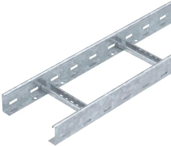
Passerella a travesini con longherone forato, con bordo di altezza pari a 60 mm, pioli del profilato a C rivettati e aperti verso l'alto (versione VS). La passerella a travesini viene fornita in versione ripiegata.
