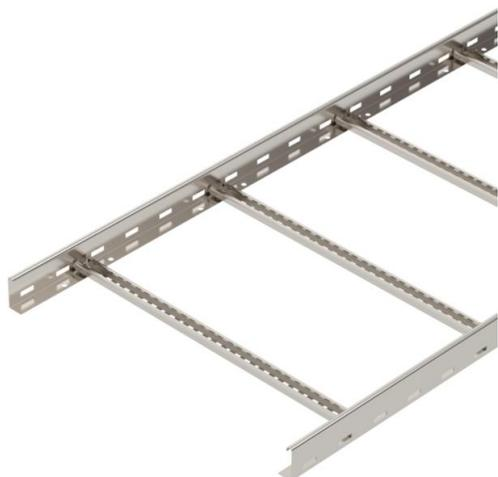
Passerella a traversini con bordo di altezza pari a 60 mm saldata, con pioli del profilato a C30 con scanalatura verso l'alto. Longherone laterale arrotondato come rinforzo e protezione dei bordi. Il fissaggio alla mensola viene eseguito con morsetti tipo LKS 40. La misura della scanalatura del piolo è pari a 16,5 mm, la staffa reggicavo è il tipo 2056. Schermatura elettromagnetica senza coperchio 10 dB, con coperchio 15 dB.
