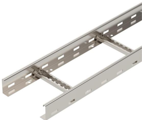
Passerella a traversini con bordo di altezza pari a 60 mm saldata, con pioli del profilato a C30 con scanalatura verso l'alto. Longherone laterale arrotondato come rinforzo e protezione dei bordi. Il fissaggio alla mensola viene eseguito con morsetti tipo LKS 40. La misura della scanalatura del piolo è pari a 16,5 mm, la staffa reggicavo è il tipo 2056. Schermatura elettromagnetica senza coperchio 10 dB, con coperchio 15 dB.
