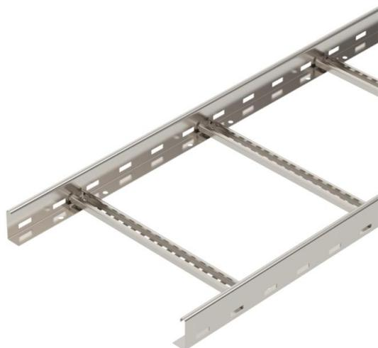
Passerella a traversini con bordo di altezza pari a 60 mm saldata, con pioli del profilato a C30 rivettati e aperti verso l'alto. Longherone laterale arrotondato come rinforzo e protezione dei bordi. Il fissaggio alla mensola viene eseguito con morsetti tipo LKS 40. La misura dell'asola del piolo è pari a 16,5 mm, la staffa reggicavo è il tipo 2056. Schermatura elettromagnetica senza coperchio 10 dB, con coperchio 15 dB.
