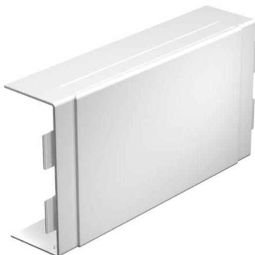
Coperchio derivazione a T e a croce per deviazione di direzione dei canali WDK. Il coperchio è preforato lateralmente per il collegamento di svariate sezioni di canale. Gli accessori sono in genere concepiti come pezzi sagomati del coperchio.
