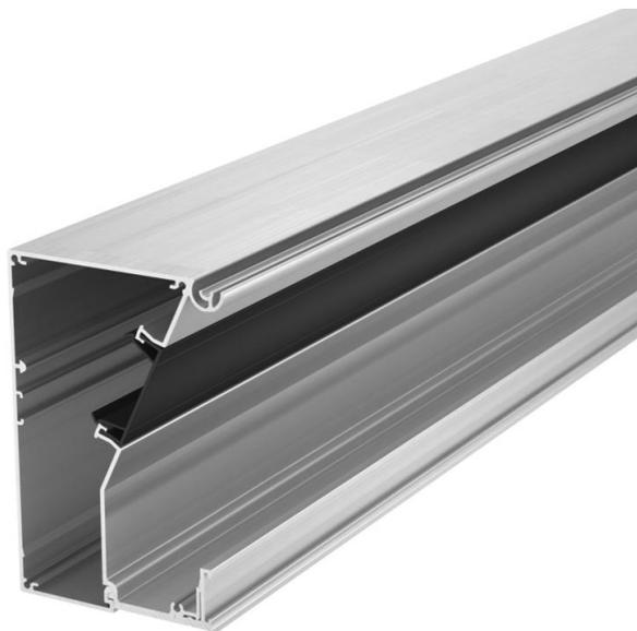
Apertura sistema da 45 mm per l'installazione di interruttori e prese Modul. Il canale può essere completato con coperchi di design "Swing", "Soft" o "Style". Gli adattatori del coperchio GAD OT sono assolutamente necessari e dovrebbero essere progettati ad una distanza max. di 50 cm sul tratto del canale. Tra le coperture canali deve essere installato un distanziatore GAD OTD. L'apertura di sistema da 45 mm nella condizione di spedizione è chiusa con una parte superiore di canale nera.
