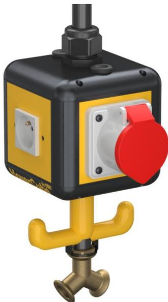
Alloggiamento equipaggiato e precablato con 1 m di tubo da 1/2" e raccordo per tubo flessibile dell'aria compressa da 13 x 3,5 mm e ripartitore a 2 vie da 1/2", con occhiello di aggancio, maniglia a gancio e 4 piastre di copertura.
